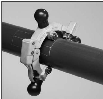
Причем, поверхность снятия оксидного слоя на трубе должна быть на несколько миллиметров больше, чем непосредственно зона контакта верхней седлообразной части изделия с трубой, что будет являться доказательством после сварки того, что оксидный слой надлежащим образом снят.
